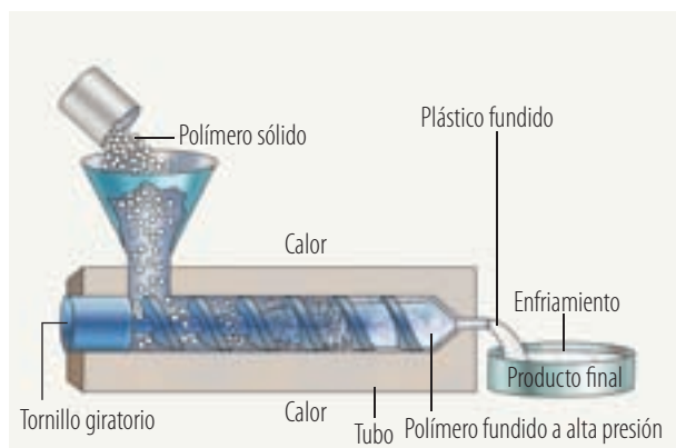
Figura 15. Esquema del funcionamiento básico de una extrusora.
