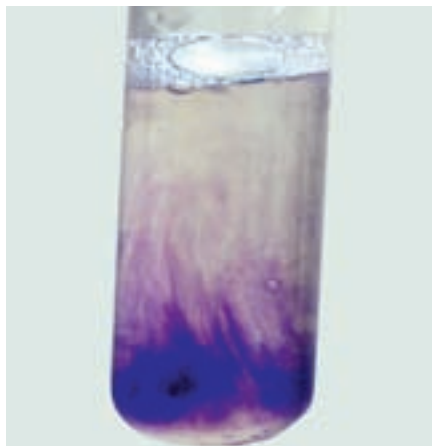
Figura 31. Reacción de Biuret para identificación de proteínas.
