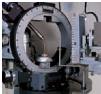
Figura 10. La difracción de rayos X es una técnica muy utilizada para determinar la distribución espacial de los átomos en una molécula.
