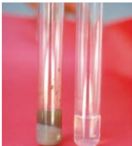
Figura 29. El reactivo de Tollens se emplea para diferenciar aldehídos de cetonas, pues los aldehídos reaccionan formando un espejo de plata en el tubo de ensayo mientras que las cetonas no reaccionan.
