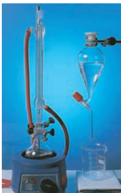
Figura 19. El análisis inmediato se lleva a cabo a través de métodos físicos, como la destilación o mecánicos como la decantación.
