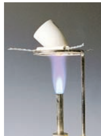
Figura 20. La calcinación es uno de los procedimientos más simples para el análisis elemental cualitativo.
