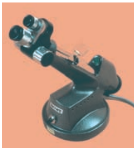
Figura 6. El polarímetro se utiliza para cuantificar la actividad óptica de los compuestos orgánicos.
